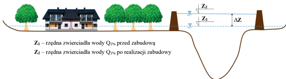
II. 2.13. Efekt oddziaływania wałów przeciwpowodziowych na zmianę wysokości zwierciadła wody w rzece
