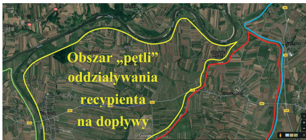
II. 2.14. Wały cokołkowe (tzw. pętla) na dopływach rzeki zabezpieczające teren zagrożony podpiętrzeniem rzeki głównej, powstającym na skutek jej obwałowania
