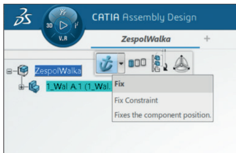
Rys. 61. Nadanie więzu montażowego typu „Fix”
