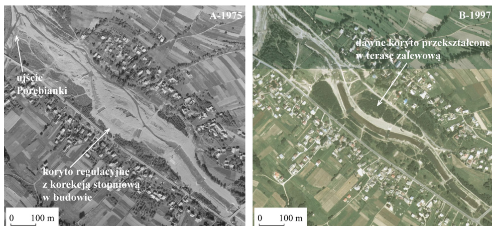
Rys. 3.20. Koryto Mszanki w Mszanie Górnej w trakcie powstawania korekcji stopniowej w 1975 r. i zmiany koryta po 22 latach
