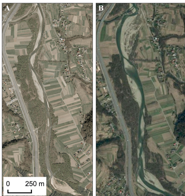
Rys. 3.39. Korytarz swobodnej migracji w dolinie Raby, utworzony samoistnie na skutek zniszczenia umocnień brzegowych i zabudowy podłużnej koryta podczas wielkiego wezbrania w 2010 r.: A) uregulowany odcinek koryta przed powodzią, B) korytarz swobodnej migracji po powodzi
