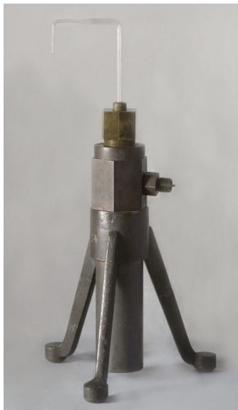
Rys. 2. Kopia aparatu Cailleteta do skraplania tlenu – Muzeum UJ
