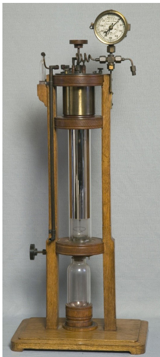
Rys. 3. Aparat do skraplania powietrza i wodoru – Muzeum UJ
