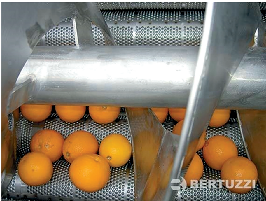
Rys. 32. Wnętrze urządzenia Bertuzzi CitroRap firmy Bertuzzi do procesu Pellatrice [58]
