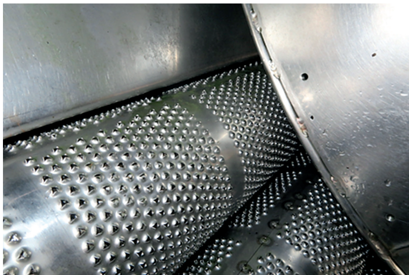
Rys. 33. Zbliżenie rolek w urządzeniu Bertuzzi CitroRap [59]
